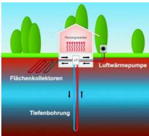
Je nach Situation kann die Umgebungsluft, das Erdreich oder das Grundwasser zur Wärmegewinnung genutzt werden.
